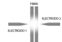
Se forma un arco eléctrico con dos electrodos sometidos a una diferencia de potencial liberando la descarga eléctrica para fusionar.
